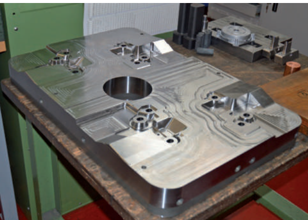
Dettaglio di parte stampante lavorata.
