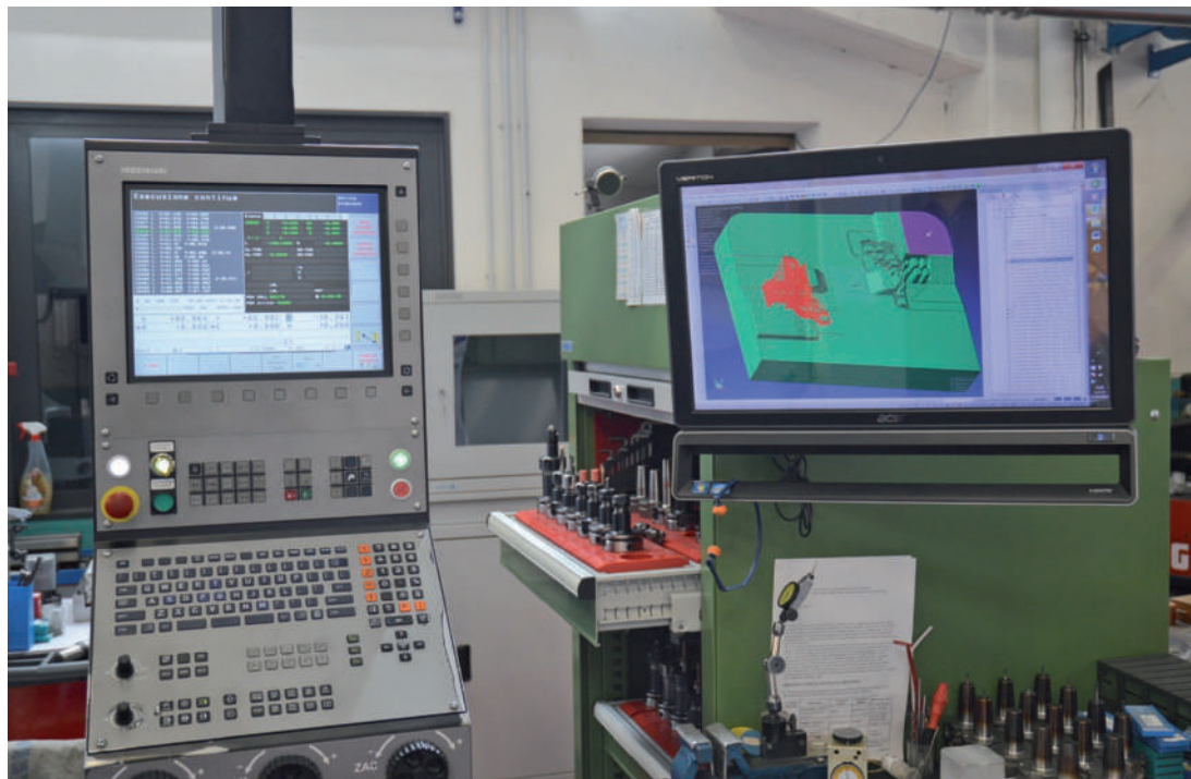
Ogni macchina utensile è munita in Romec di monitor per visualizzare modelli 3D, percorsi utensile e commessa da lavorare.
